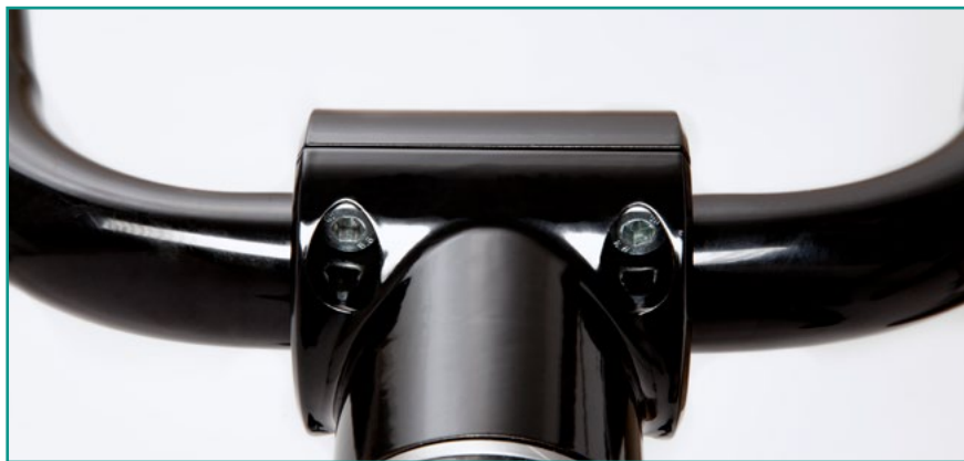
Abbildung 5: Lenkerklemme mit vier Schrauben
